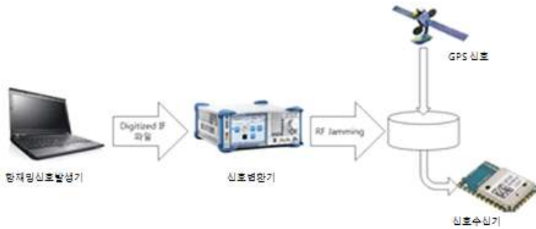
〈그림 1〉 신호발생기를 이용한 실험실 테스트
