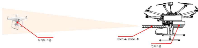
<그림 3> 안티드론의 탑재로 악의적 드론 제압 시험
