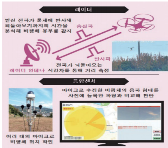
〈그림 12〉 세콤 드론 감지시스템 기본 구조
