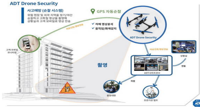
〈그림 5〉 ADT캡스 드론 기반 순찰 시스템 개념도
